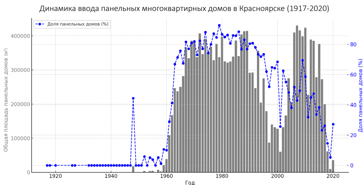
а) Проявление эффекта затягивания цикла панельного домостроения
